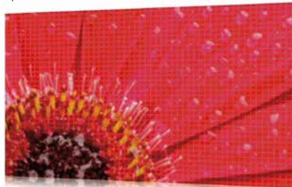
Typischer Fliegengittereffekt bei Projektoren ohne SXRD-Technologie
