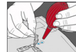
Direkter Zugriff auf die drei LCD-Panels: mit dem kleinen Blasebalg, dem „Hurricane Blower“, macht sich Staub schnell aus dem Staub.
