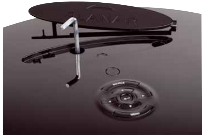
Hinter dem Schriftzug versteckt: Nach Entriegelung der Klappe durch einen leichten Druck auf dieselbe, lässt sich das Lens-Shift mittels eines Inbusschlüssels horizontal und vertikal justieren
