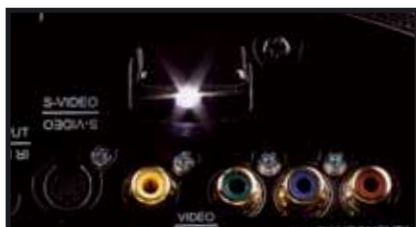
Eine weitere Detaillösung, auf die Planar stolz sein darf: Nach Betätigung der Light-Taste auf der Fernbedienung für einige Sekunden, erleuchtet eine Diode an der Rückseite, die auch einen Anschluss in der Dunkelheit ermöglicht
