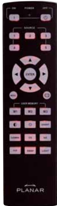
Der Infrarotsender des Planar ist schlicht und funktional. Die Quellen 1-5 sind frei programmierbar, und die wichtigsten Bildjustagefunktionen sind per Direkttaste aufrufbar. Jeder Tastendruck lässt den Geber in schickem Rot erleuchten
