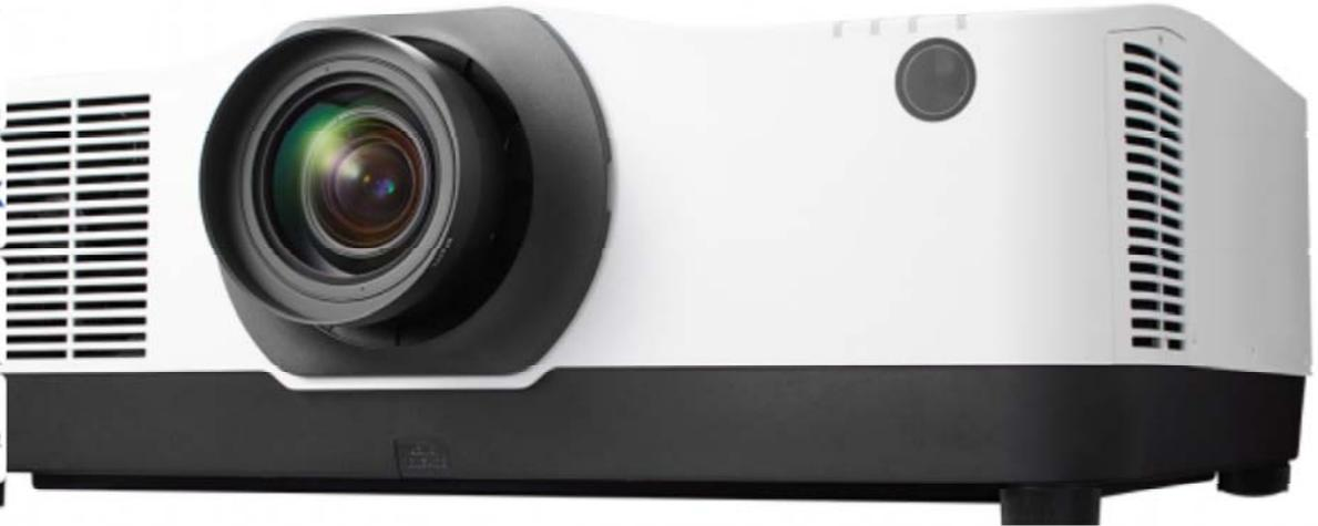
Der PA804UL kurz vorgestellt: Der Nec Stationär 3D Laser LCD Projektor bietet 7500 Ansi-Lumen einen Kontrast von 3000000:1 und eine WUXGA 1920 x 1200 Auflösung. Es ist ein Laser Projektor mit 20000 Stunden Licht Lebensdauer, was umgerechnet über 13.7 Jahre bei 4 Stunden täglich wären. Die eingebaute Lens Shift und Keystone-Korrektur Funktion, bringt Freiheit bei der Projektions-Anpassung.
