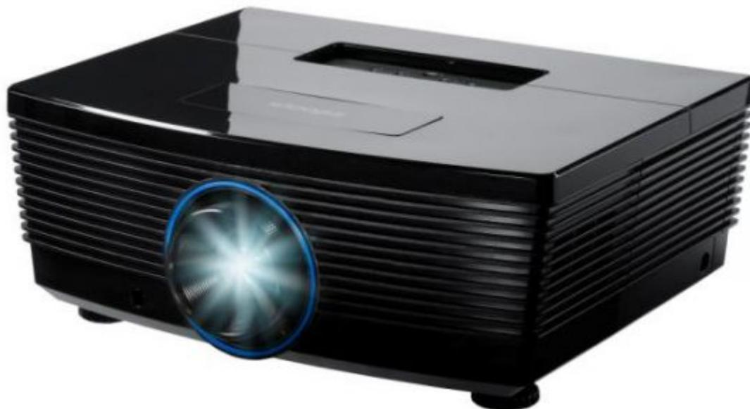
Hersteller InFocus bietet mit dem IN5318 einen Standard-Portabel DLP Projektor mit WUXGA 1920 x 1200 Auflösung und einem Kontrast von 2000:1 an. Der integrierte Lens Shift gibt Freiheit beim Aufstellen des Projektors.
