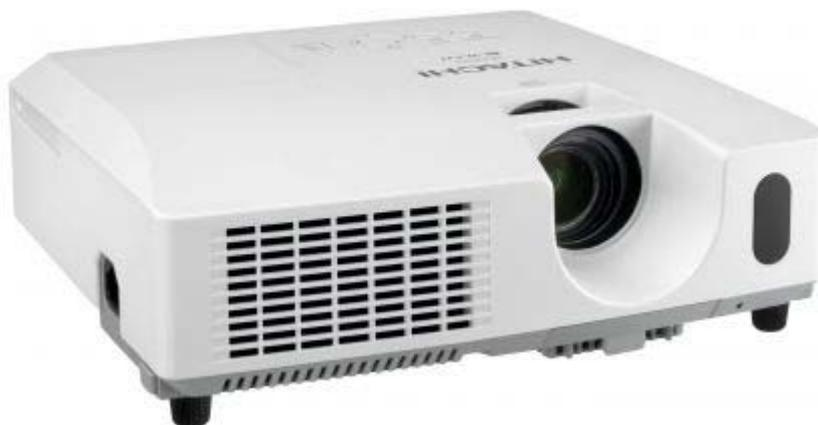
Kurze Vorstellung des Hitachi CP X4011N. Der LCD Projektor hat eine XGA 1024 x 768 Auflösung und einen Kontrast von 2000:1. Inklusive eines integrierten Mediaplayer, mit dem sich Dateien direkt abspielen lassen.
