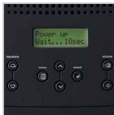
Ein 12-sprachiges, interaktives Display bietet Statusinformationen in Echtzeit. Das Anwender freundliche Tastaturfeld ermöglicht die Steuerung der meisten Funktionen mit einem Tastendruck.
