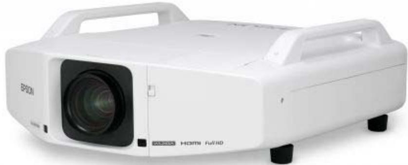
Der Stationär PowerLite Z8050W/NL LCD hat 7000 Ansi-Lumen einen Kontrast von 5000:1 und eine WXGA 1280 x 800 Auflösung. Der integrierte Lens Shift gibt Freiheit beim Aufstellen des Projektors.
